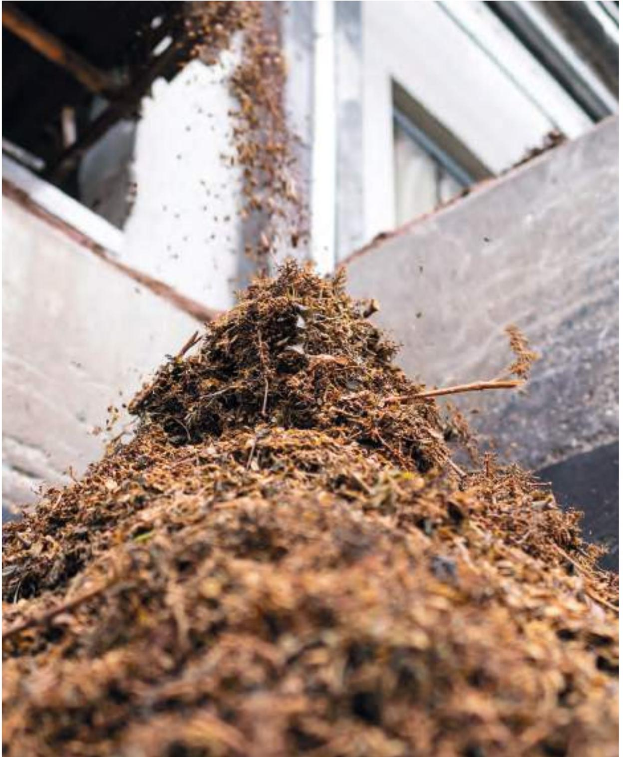
dell'alimentazione dell'impianto. Il raggiungimento di tale obiettivo è stato reso possibile mediante un ulteriore investimento, l'impianto di tritovagliatura, che separa la frazione grossolana delle potature del verde pubblico, destinata alla centrale termica, dalla frazione fine che invece viene avviata al processo di compostaggio.
